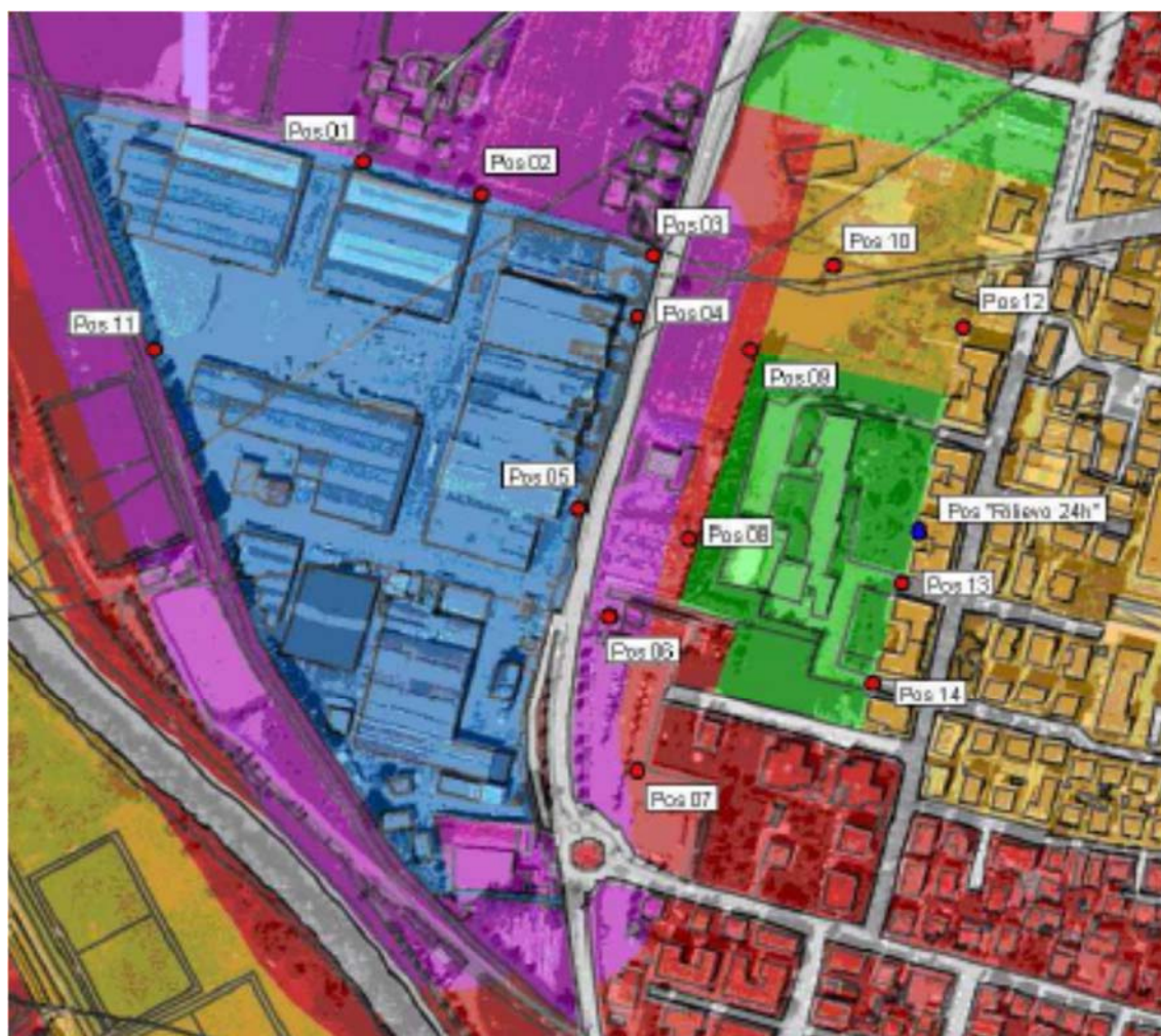
Figura 19 - Classificazione acustica e posizione dei punti di rilievo nel circondario dello stabilimento Bormioli Luigi Spa
