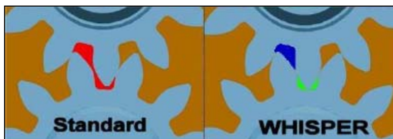
Figura 2.15. Confronto delle oscillazioni di pressione generate dalle due pompe
