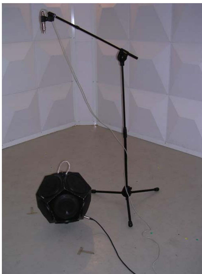
Figura 6.1. Una fase della caratterizzazione della camera anecoica
